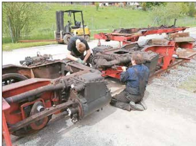
André Dörfelt und Kevin Richter beim Trennen der beiden Drehgestelle. Im Hintergrund steht der abgebaute Lokrahmen.
