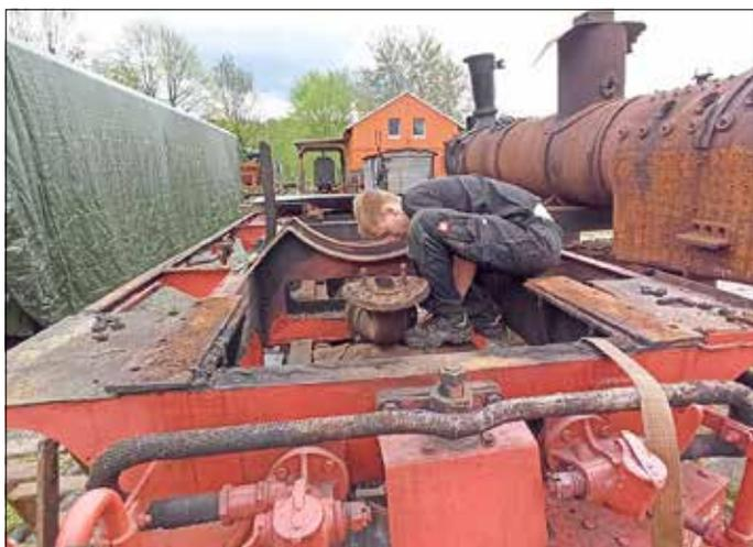
Kevin Richter beim Ausbau von Teilen der Bremsanlage und Lösen des Lokrahmens von den Drehgestellen.
