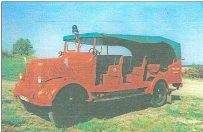
Im Jahr 1951 bekamen die Phänomenwerke Zittau von der Regierung der DDR den Auftrag, Zugfahrzeuge für die Feuerwehren, Kasernierte VP und Kampfgruppen herzustellen. 1952 wurden Sonderkraftfahrzeuge für die KVP hergestellt (sogenannte Streifenwagen 10). Das war meine Stunde der Entstehung. Hersteller: VEB Phänomen Zittau
