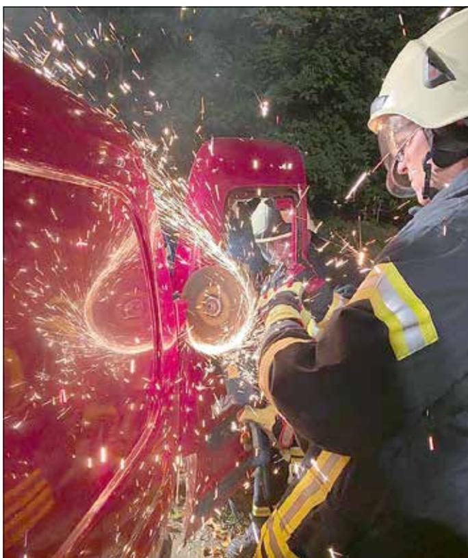
*Abtrennen der hinteren Tür mittels Trennschleifer*
